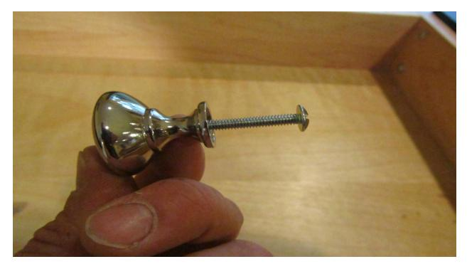
Insert Screw And Attaching A Non Standard Knob
